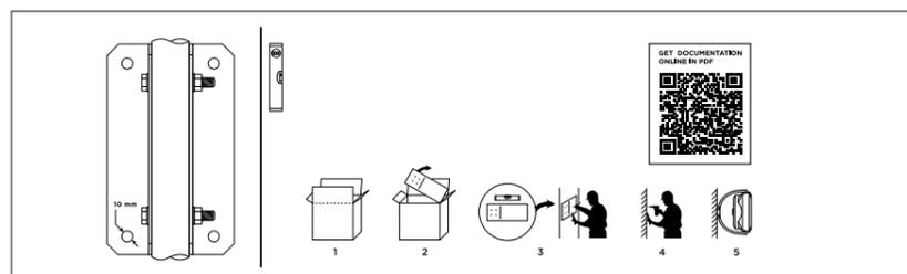
На картонной упаковке агрегатов VOLCANO нанесён шаблон с указанием монтажных размеров между крепежными отверстиями и линиями для горизонтального монтажа, облегчающий крепление консоли к стене. Достаточно отрезать шаблон с верхней части упаковки и можно приступить к монтажу агрегата.
